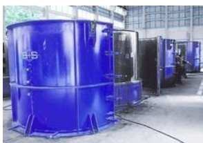
Neue Produktionstechnik: Aus Stahlformen werden nach dem Gießen fugenlose Betonbehälter, beispielsweise für Kleinkläranlagen, entnommen.
